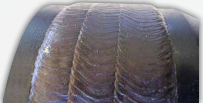
钻具接头OTW 10SS 耐磨带
