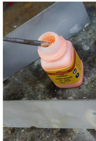
Fabriqué dans notre usine de Villebon-sur-Yvette, France, le décapant GreenFlux 1600 PF Atmosin est constitué d'un mélange de sels complexes de fluoroborates de potassium sans acide borique ou borax. Il est destiné au brasage capillaire à l'aide d'alliages à haute teneur en argent. Ce décapant de brasage fort est actif sur cuivre, laitons, bronzes, aciers et aciers inoxydables.
