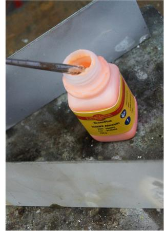
Das neue Flussmittel GreenFlux 1600 PF Atmosin basiert auf einer innovativen Kombination von komplexen Salzen aus Kalium-Fluorborat, völlig frei von Borsäure oder Borax. Entwickelt wurde dieses Flussmittel für Kapillarlötungen unter Verwendung von hochsilberhaltigen ternären oder quaternären Legierungen (CASTOLIN - 1655 - 1665 - 1666 - 1800).
