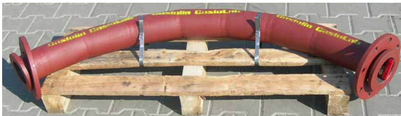
Coude de diamètre interne 100mm avec flasques (ci-dessous) et vue détaillée (droite)
