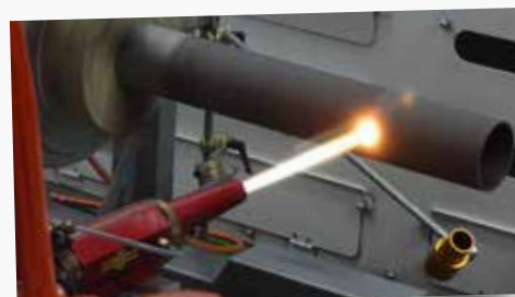
Ensayos de recargue con HVOF
