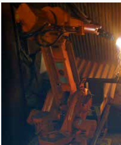
Proceso de recarga automatizado
